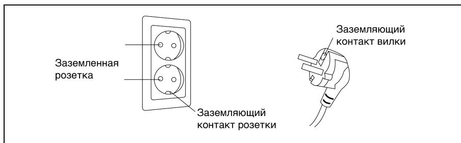
Рисунок 21 — Правильное заземление массажного кресла
