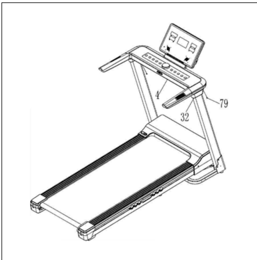
Рисунок 4 — Установка декоративных заглушек под консолью
