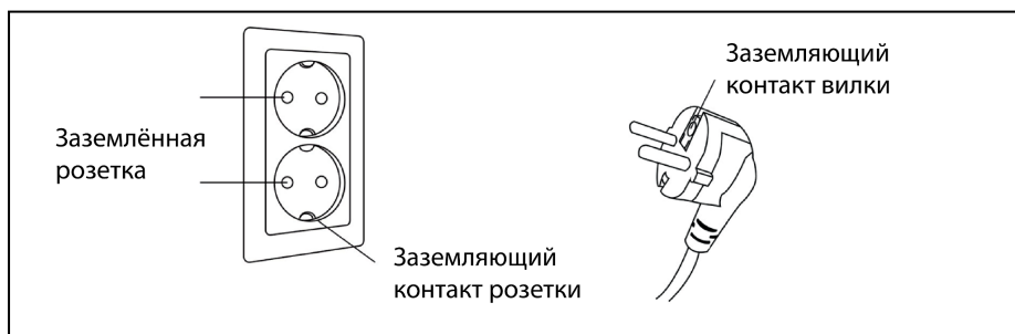
Рисунок 42 — Правильное заземление массажного кресла
