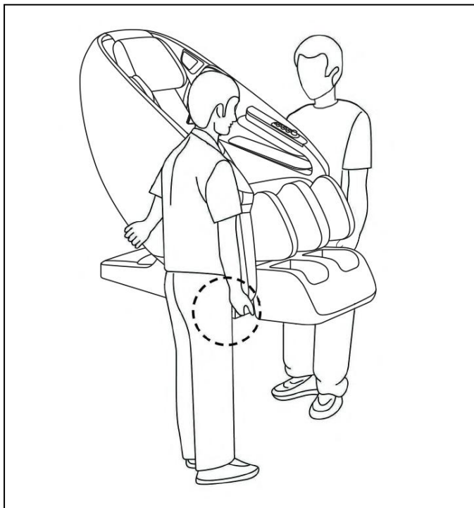
Рисунок 17 — Перемещение массажного кресла без использования транспортировочных роликов
