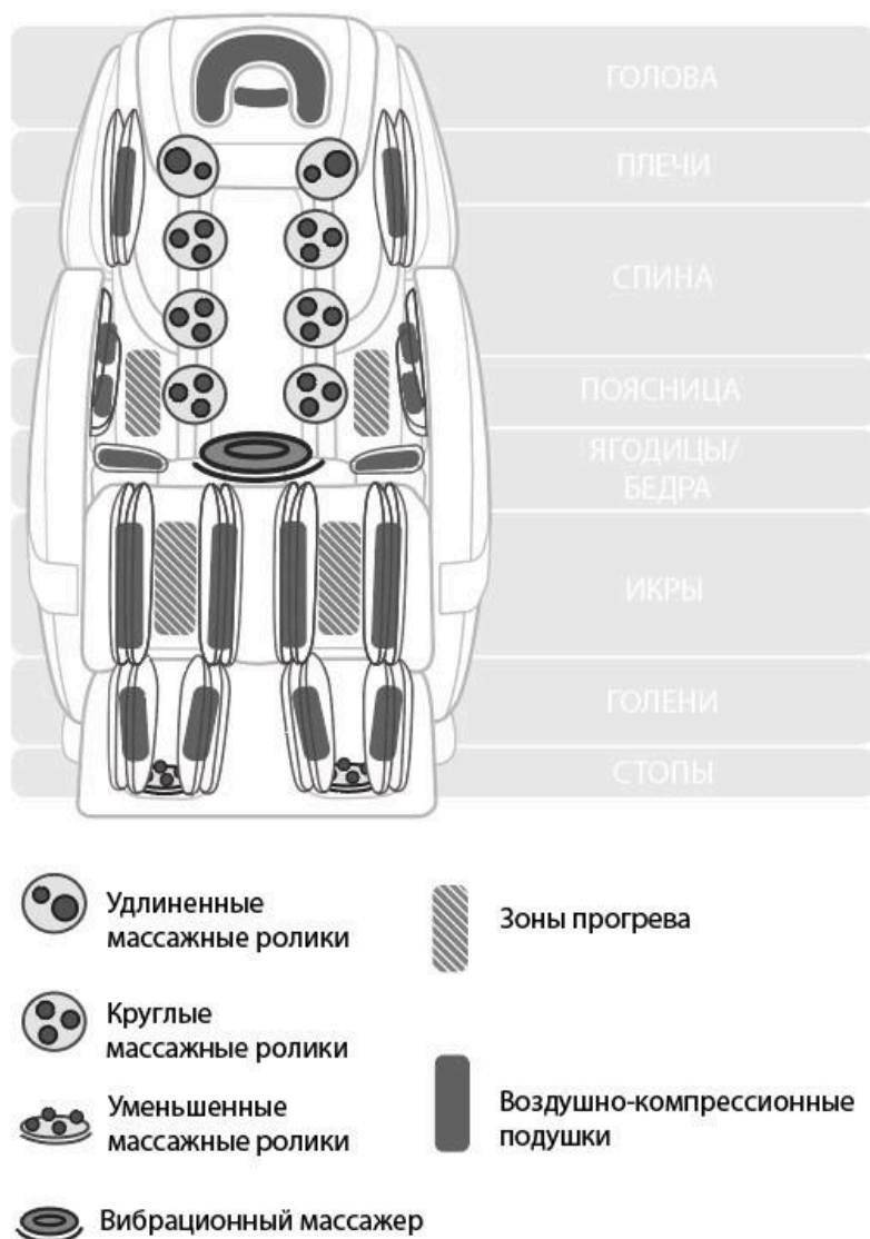
Рисунок 2 — Детали массажного механизма
