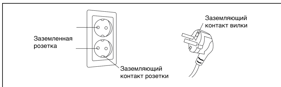
Рисунок 15 — Правильное заземление массажного кресла
