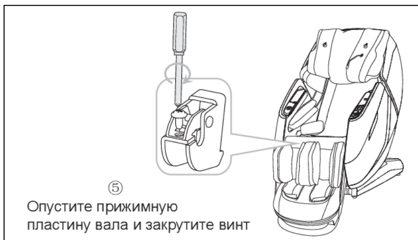
Рисунок 20 — Установка секции для ног
