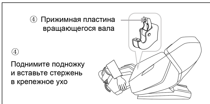
Рисунок 19 — Установка секции для ног
