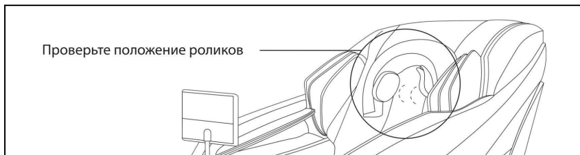
Рисунок 13 — Правильное положение роликов
