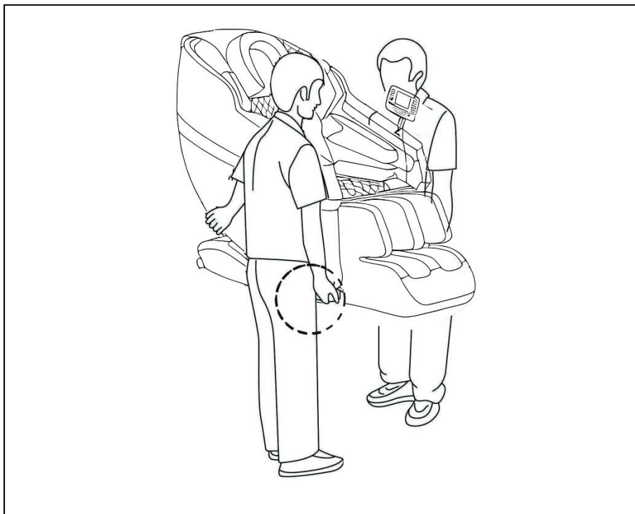
Рисунок 5 — Перемещение массажного кресла без использования транспортировочных роликов
